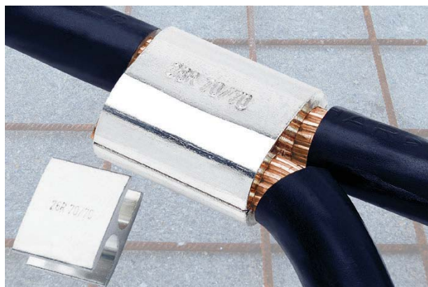
H-образные соединительные зажимы испытаны токами грозовых разрядов по станд. EN 50164,1 Класс H (100 кА 10,350 мкс).
